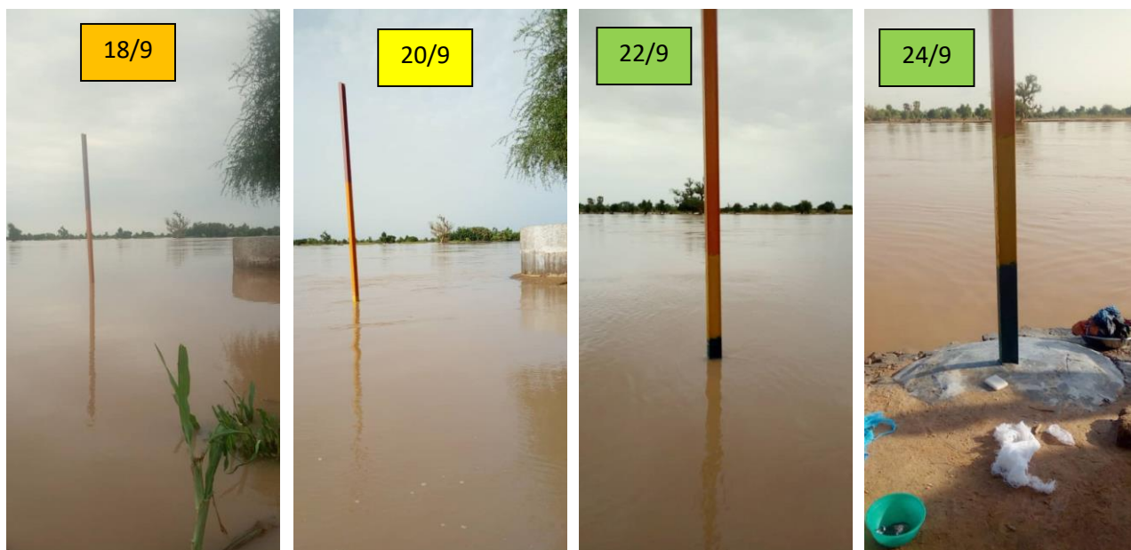
Figure 4 – Echelle colorée de Larba Birno (Rivière Sirba) entre le 18/9 (gauche), le 20/9, le 22/9 et le 24/9 (droite) : les couleurs des dates sur les photos signalent la couleur de la vigilance hydrologique.
